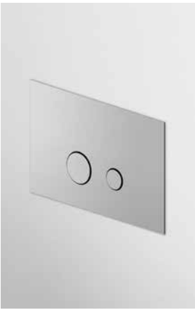
PLACA PARA CISTERNA Placa de accionamiento en acero inox, enganche magnético, sin fijacion visible. Compatible con Geberit Sigma 8 y Sigma 12. Empotrado mínimo de la caja Geberit: 25 mm. Plaque de commande en acier inox branchement magnétique sans fixations à vue. Produit compatible avec Geberit Sigma 8 et Sigma 12. Encastrement minimum du boîtier Geberit: 25 mm.
